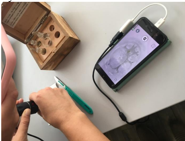
Рис. 4. Процесс определения наполнителя авторского левкаса под электронным микроскопом и фиксация данного процесса на камеру.
